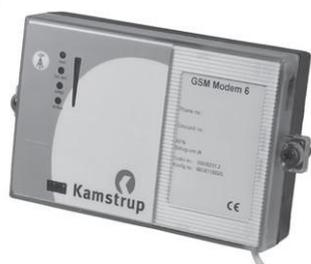
**GSM Модем 6** применяется для удаленного считывания электросчетчиков с помощью dial-up соединения, обычно через концентратор, который позволяет считывать данные нескольких счетчиков одним вызовом. GSM Модем 6 позволяет загружать новые прошивки удаленно. Передача данных производится в прозрачном режиме, сопровождается контрольными суммами CRC и контролируется программой PC с диспетчерской станции. Используются Hayes AT команды протокола версии V.110.
